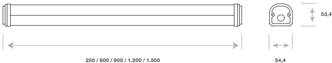
IK08: Ausschließlich bei Verwendung der Leuchte mit Montageplatte.
