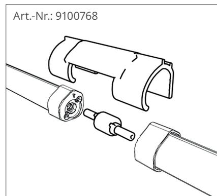
Der Leistenverbinder mit der Leistenverriegelung ist zur Kaskadierung der LCR-H asym.
