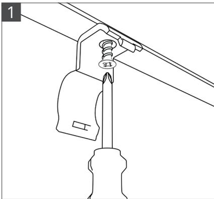
1. Achten Sie vor der Verwendung der empfohlenen Schrauben dass keine Kabel oder Leitungen im Kühlgerät beschädigt werden können.
