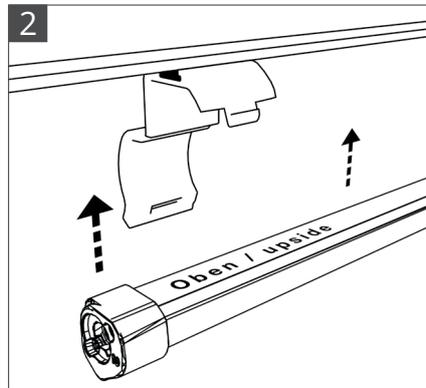
2. Die richtige Positionierung der Leisten wird durch die Montagesymbole Oben / upside oder Rückseite / back side unterstützt. Der Magnet muss immer auf der Fläche der Montagesymbole sein.
