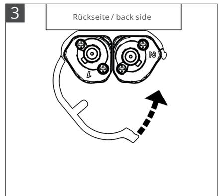
3. Schließen Sie den Doppelclip. Wenn der Clip sich nicht bequem schließen lässt, prüfen Sie bitte ob die Leisten wie im Bild 2 beschrieben richtig eingesetzt wurden.
