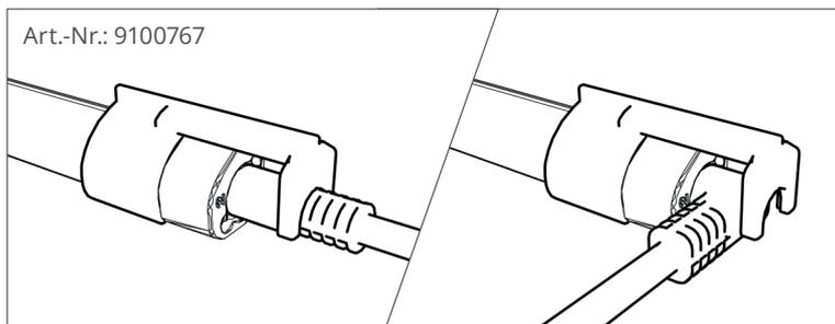
Die Steckerverriegelung ist für alle LCR Typen (außer LCR-CD). Pro Einspeisung immer eine Steckerverriegelung.
