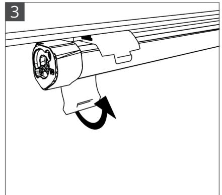
3. Schließen Sie den Magnetclip. Wenn der Magnetclip sich nicht bequem schließen lässt, prüfen Sie bitte ob die Leisten wie im Bild 2 beschrieben richtig eingesetzt wurden.
