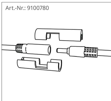
Die Steckerverriegelung ist nur für LCR-CD. Pro Einspeisung immer eine Steckerverriegelung (2er-set) zu verwenden.
