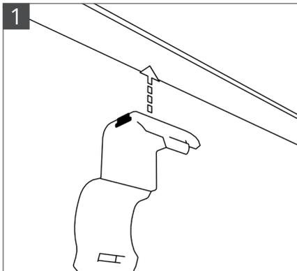
1. Befestigen Sie den Magnetclip an die dafür vorgesehene metallische Endposition.
