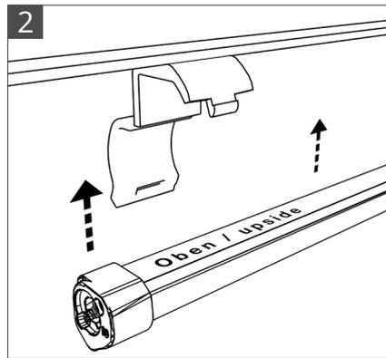
2. Die richtige Positionierung der Leisten wird durch die Montagesymbole Oben / upside oder Rückseite / back side unterstützt. Das Bohrloch oder der Magnet muss immer auf der Fläche der Montagesymbole sein.
