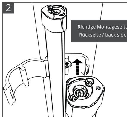
2. Bei der Montage der LCR-VC ist darauf zu achten dass die Montagesymbole Rückseite / back side auf der Seite des Türstegs angebracht sind.
