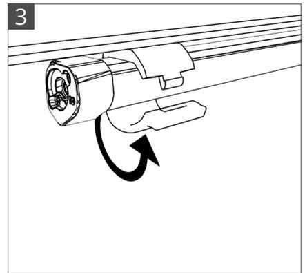
3. Schließen Sie den Schraubclip. Wenn der Schraubclip sich nicht bequem schließen lässt, prüfen Sie bitte ob die Leisten wie im Bild 2 beschrieben richtig eingesetzt wurden.
